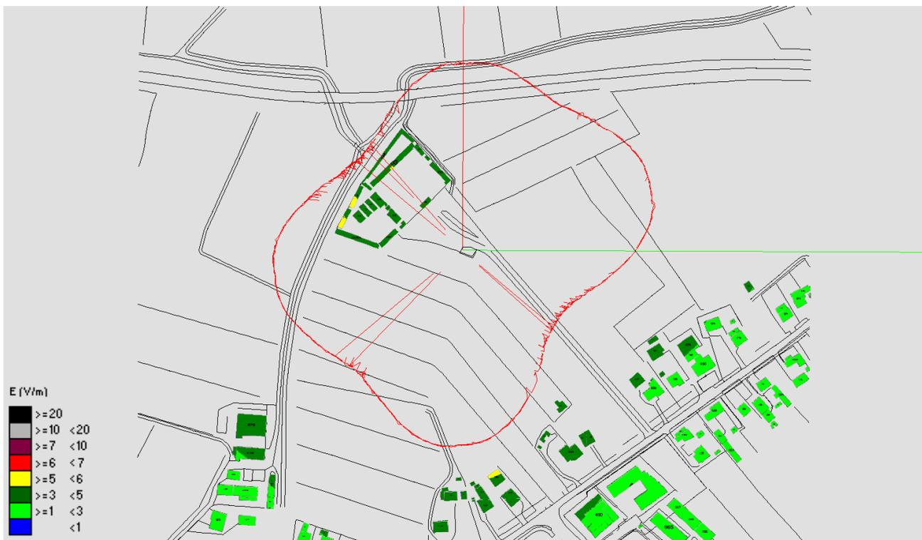
Fig. 3 Impatto elettromagnetico – Zona Cimitero Via A.Diaz c/o Onair – Vista dall'alto
