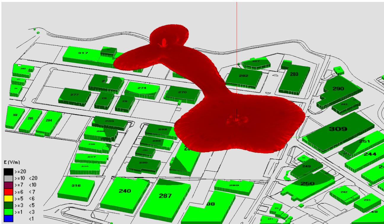
Fig. 2 Impatto elettromagnetico – Zona Via delle Industrie – 0°/Nord
