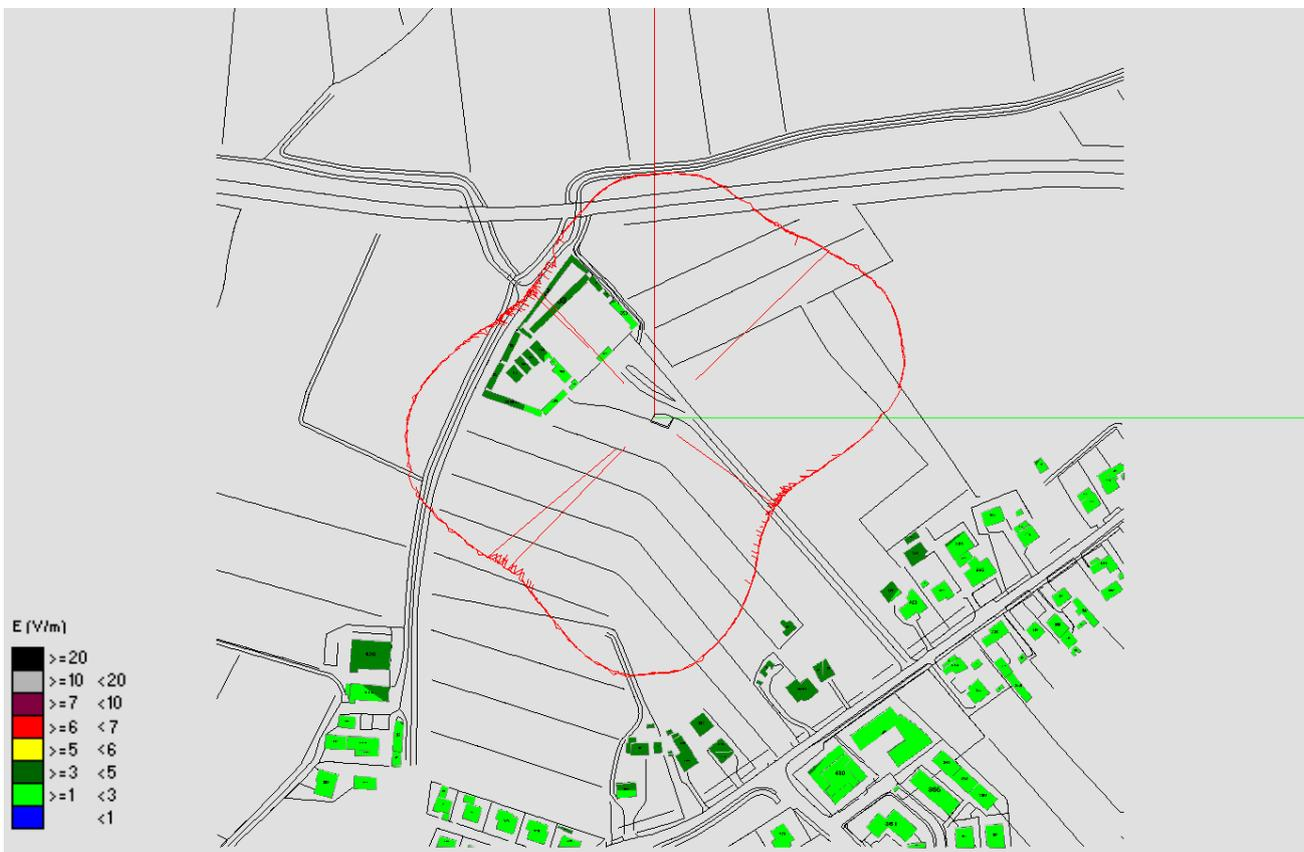
Fig. 3 Impatto Elettromagnetico – zona Cimitero Via A.Diaz co Onair – Vista dall'alto senza solido
