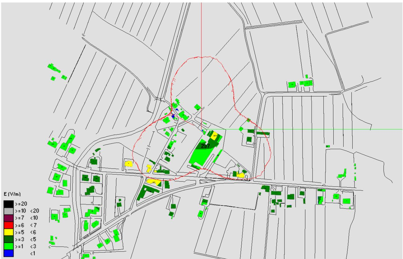
Fig. 18 Impatto Elettromagnetico – zona Area Industria Cipriani – Vista dall'alto senza solido
