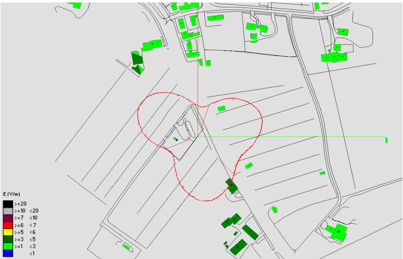
Fig. 28 Impatto Elettromagnetico – zona Area Ecocentro – Vista dall'alto senza solido
