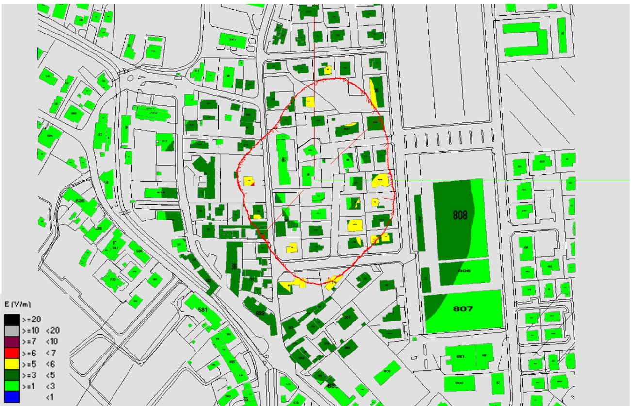
Fig. 8 Impatto Elettromagnetico – zona Via A.Diaz co Onair – Vista dall'alto senza solido
